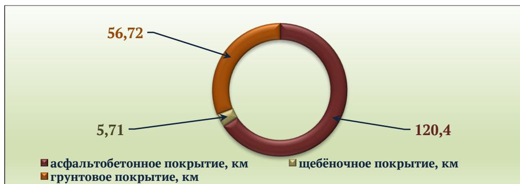
**Распределение автомобильных дорог местного значения,
